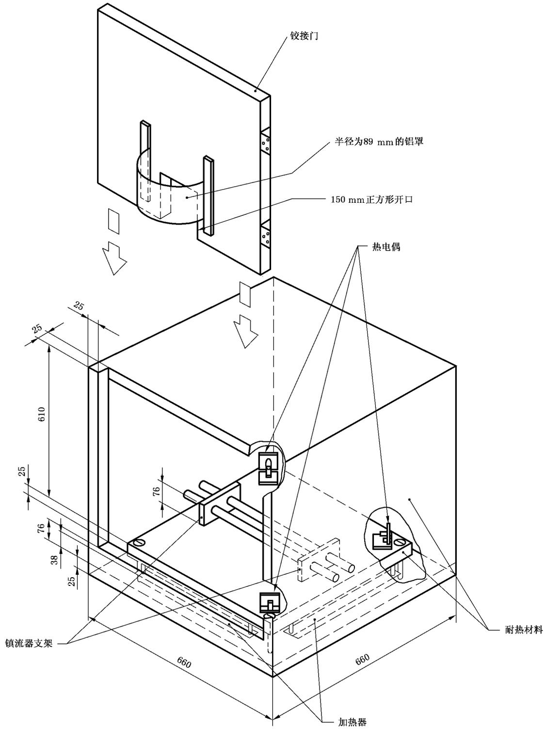
图 D.1 热保护式镇流器加热试验箱
