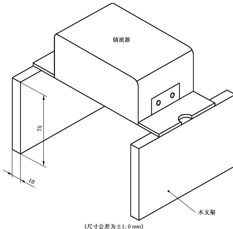
图 H.1 加热试验样品配置图
